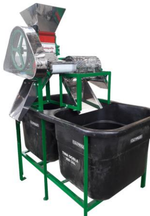
Modulo Clasificador integrado 2½ de 300 kilos de café cereza por hora con motor eléctrico de ½ hp, zaranda circular y Tanques tina (2x350L) con base.
